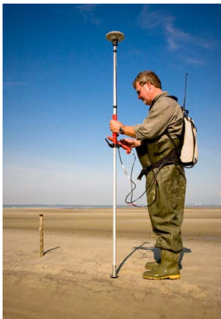
Figuur 2` : RTK meting bij een sedimentatie/erosie punt
