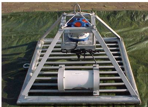
Figuur 3 ADCP geplaatst in meetframe
